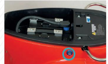
b. Disjonctez votre véhicule en plaçant le disjoncteur sur "OFF".
