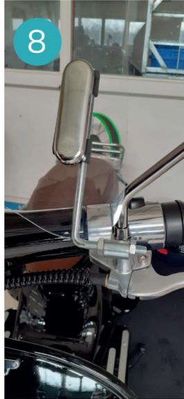
5. Installer les fixations plastiques sur les tiges chromées ainsi qu'un écrou
