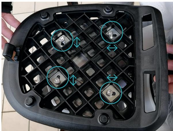
**2.** Positionnez le nid d'abeille et mettez les 4 supports de vis dans les alvéoles situées au-dessus des trous en suivant le sens des glissières comme sur la photo. Insérez les vis BTR de biais en soulevant le nid d'abeille et vissez légèrement, suffisamment pour faire tenir le nid d'abeille.
