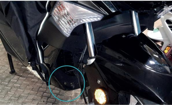
6. Il y a des trous sur des petites lanières sur les côtés. Vous pourrez ainsi les fixer grâce à des vis présentes sur la carrosserie du scooter. Revissez en incorporant les lanières. La vis présente sur la deuxième image se situe à l'intérieur du carénage, côté roue.
